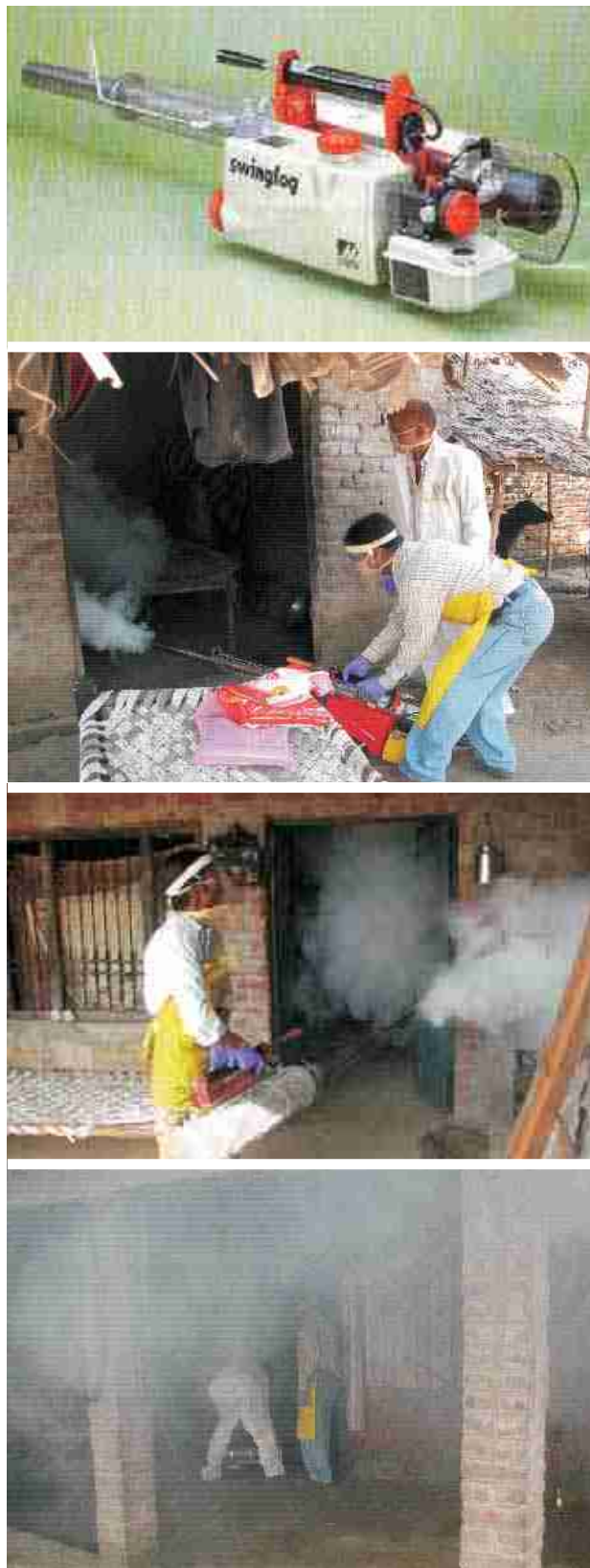
Fig. 21. Cyphenothrin fogging using swingfog machine
